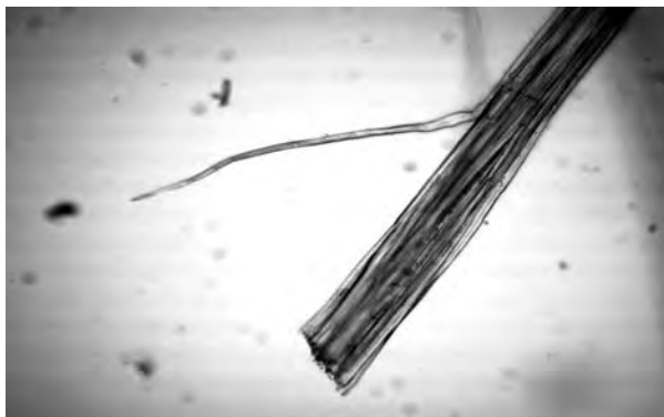
Fig. 9 Fascio di fibre di Bixa orellana L. Si nota il distacco di una fibra dal fascio attraverso il metodo di macerazione (100x). A bunch fibers of Bixa orellana L., showing a single fiber after soak (100x).
