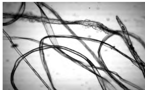
Fig. 7 Fibre di Aquilaria agallocha Roxb. con andamento a forma di nastro e cuticola molto spessa (100x). Fibers of Aquilaria agallocha Roxb. with ribbon shape, and thick cuticle (100x).
