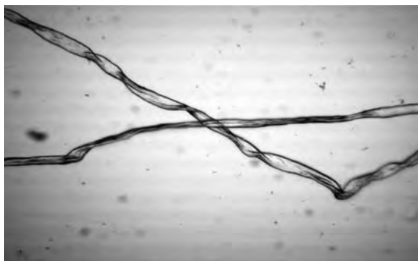
Fig. 20 Fibre di Gossypium religiosum L. a forma di nastro appiattito con pochi avvolgimenti a spirale (100x). Gossypium religiosum L. fibers with flattened ribbon and spiral windings (100x).
