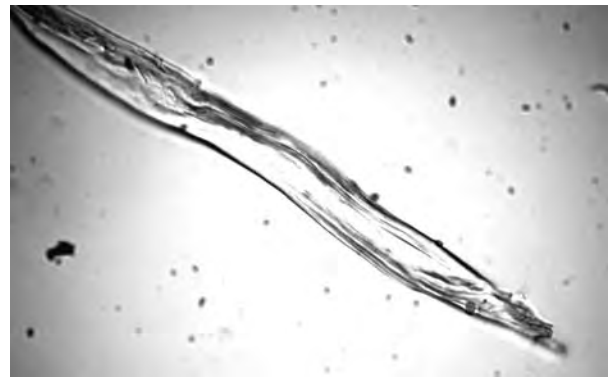
Fig. 6 Fibra di Aquilaria agallocha Roxb. con la punta a forma di giavelotto, ed il lume poco visibile (400x). Fibre of Aquilaria agallocha Roxb. with javelin termination and not much visible narrow duct (400x).
