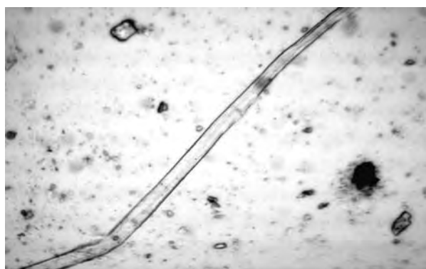
Fig. 23 Fibra di Guazuma ulmifolia L. a forma di nastro trasparente. Si nota la presenza di cristalli rilasciati dalla fibra dopo la lisciviazione (100x). Guazuma ulmifolia L. fiber with transparent ribbon shape. The photo shows the presence of crystals after leaching (100x).
